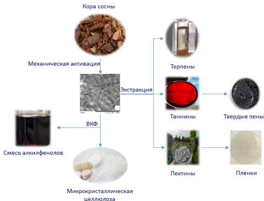
Принципиальная технологическая схема комплексной переработки коры сосны
