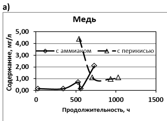
Рисунок 6. Содержание меди в обогащенном растворе модифицированных гуматов в зависимости от: а) – продолжительности процесса; б) скорости истечения раствора
