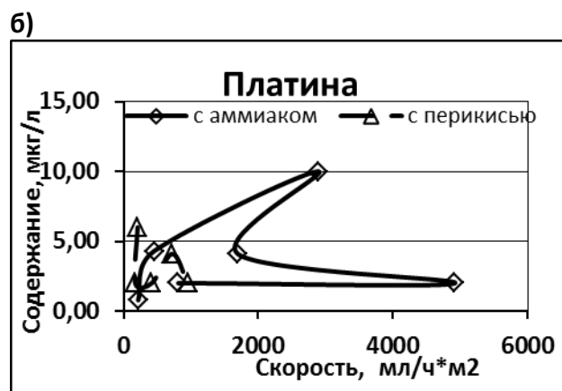
Рисунок 8. Содержание платины в обогащенном растворе гуминовой кислоты в зависимости от: а) – продолжительности процесса; б) скорости истечения раствора
